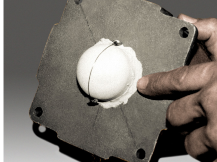
Ceramabond 571 ummantelt einen Sauerstoffsensoren.
