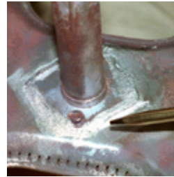
Pyro-Putty 653 versiegelt korrodierten Brennerverteiler an.
