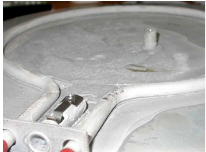
Pyro-Putty verklebt Heizung.
