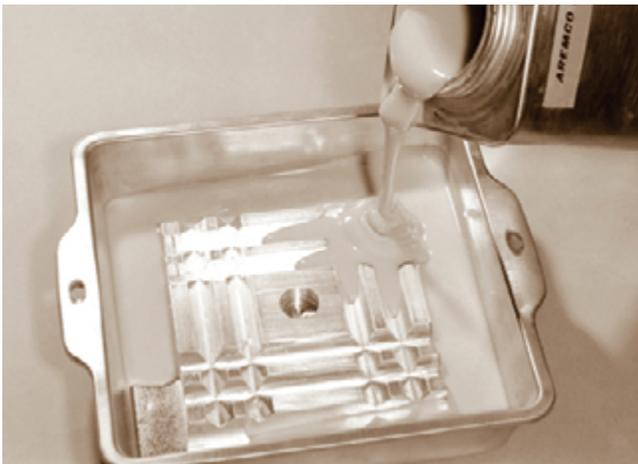
Legen Sie die bearbeitete Masterform, ein Duplikat des fertigen Guss, in eine Pfanne und gieße das EZ-Cast über den Master.
