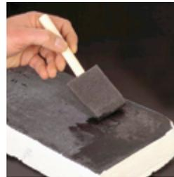
Hi-Coat 840-C als Beschichtung für Keramikfaserplatten in Infrarotheizungen.
