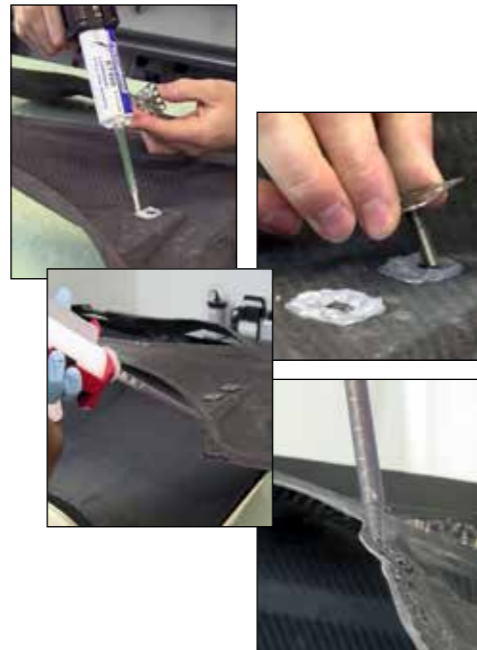
Permabond ET500 wird verwendet, um Versteifungselemente auf kohlefaserverstärkte Motorhauben zu verkleben. Permabond PT326 verbindet die Unterschale mit der Außenhaut einer Motorhaube aus Kohlefaserwerkstoff.
