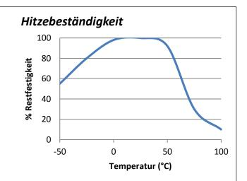
"Hitzebeständige" Scherfestigkeitsversuche wurden auf Weichstahl durchgeführt. Aushärtung bei Raumtemperatur über 24 Stunden. Vor den Testversuchen wurden die Teile über 30 Minuten auf der Testtemperatur gehalten.
