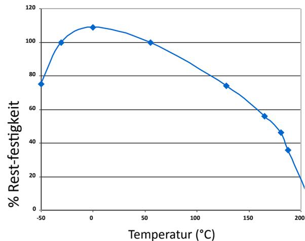
„Hitzebeständige“ Scherfestigkeitsversuche wurden auf Weichstahl durchgeführt. Aushärtung bei Raumtemperatur über 24 Stunden. Vor den Testversuchen wurden die Teile über 30 Minuten auf der Testtemperatur gehalten.
