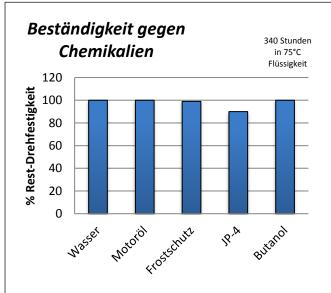
Dieses Produkt ist nicht geeignet für Verbindungen, die in direktem Kontakt mit Dampf oder reinem Sauerstoff stehen. Ein längerer Kontakt mit starken Säuren, Laugen oder stark polaren Lösungsmitteln ist zu vermeiden. Warnung: Das Produkt könnte u.U. einige Thermoplaste angreifen. Dem Anwender wird daher empfohlen, vor Gebrauch eine entsprechende Verträglichkeitsprüfung durchzuführen.
