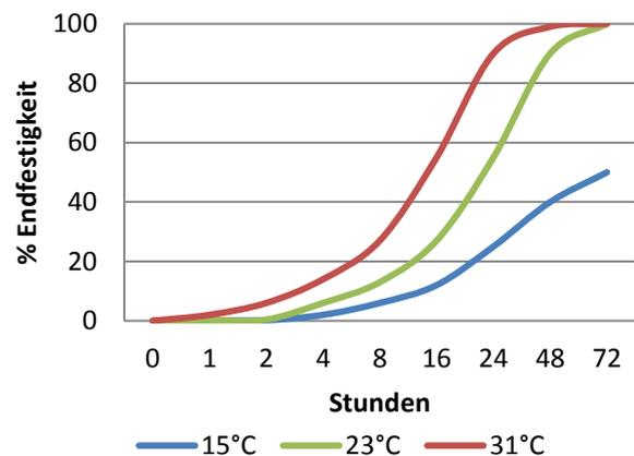
Das Diagramm zeigt den typischen Aufbau der Festigkeit bei der Verklebung von Probestücken. Wird die Temperatur um 8°C erhöht, halbiert sich die Aushärtezeit. Niedrigere Temperaturen haben eine langsamere Aushärtung zur Folge.
