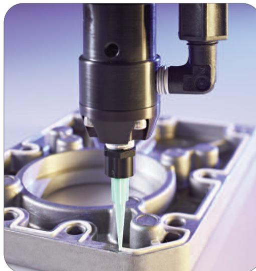
TS5322 - Dichtungsauftrag
