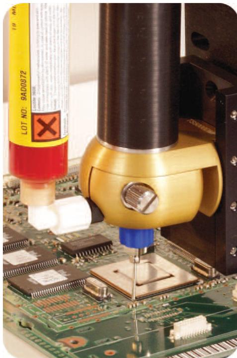
TS5000DMP – bei einer Underfill-Anwendung
