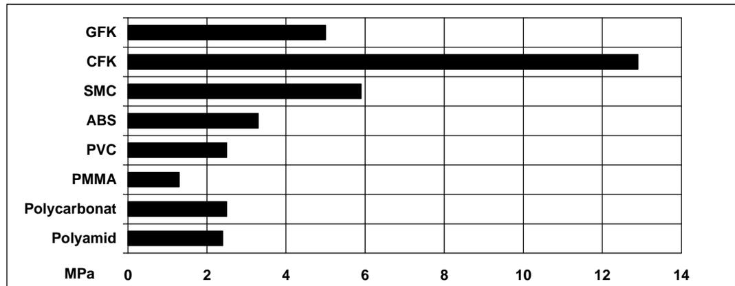
**Zugscherfestigkeit in Abhängigkeit von der Temperatur (ISO 4587) (typische Mittelwerte)**
