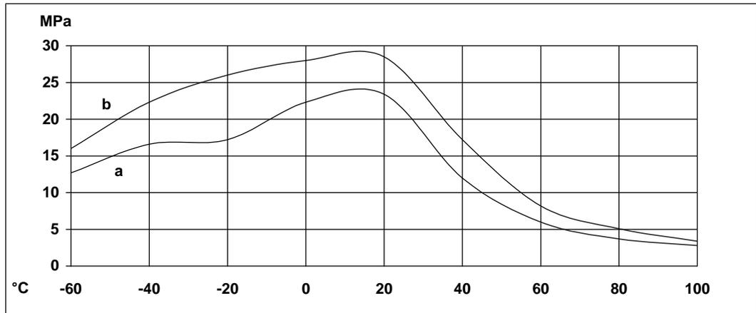
**Rollenschälversuch (ISO 4587)** Härtung 16 Stunden/40°C
